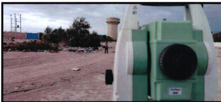
IMAGEN N°01. Levantamiento topográfico con Estacion Total Leica, levantamiento del Vertices del Predio.
