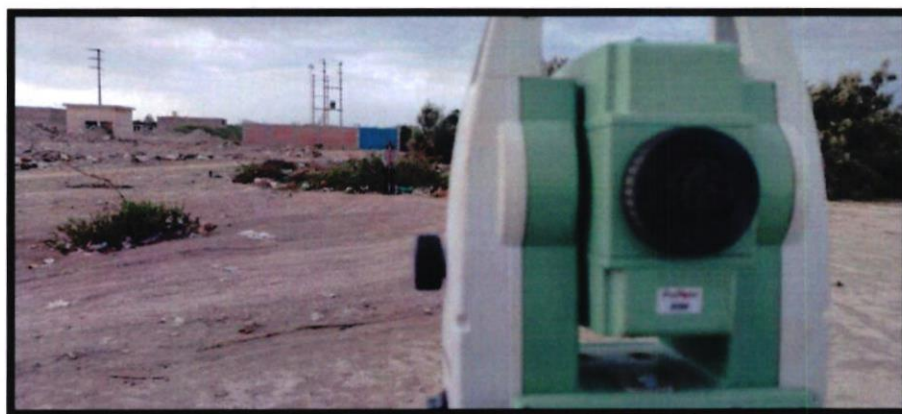
IMAGEN N°02. Levantamiento topográfico con Estacion Total Leica, levantamiento de áreas Verdes, Postes etc.
