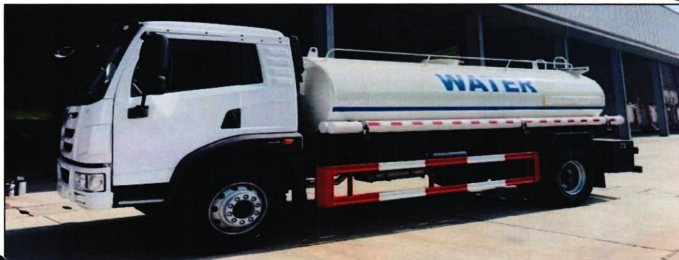
Gráfico 113: Cisterna de 3000 galones 6 x 2 con pistola neumática
