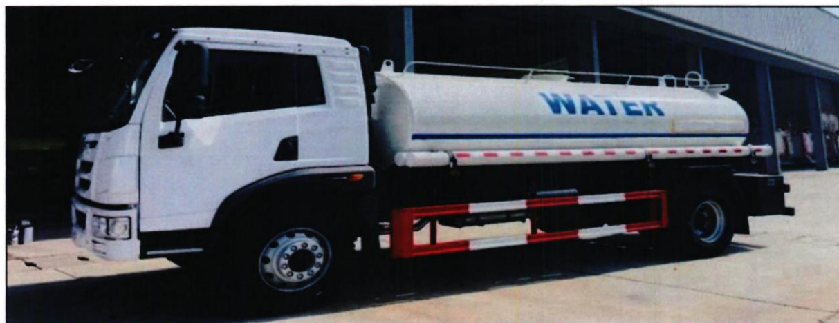
Gráfico 18: Cisterna de 3000 galones 6 x 2 con pistola neumática
