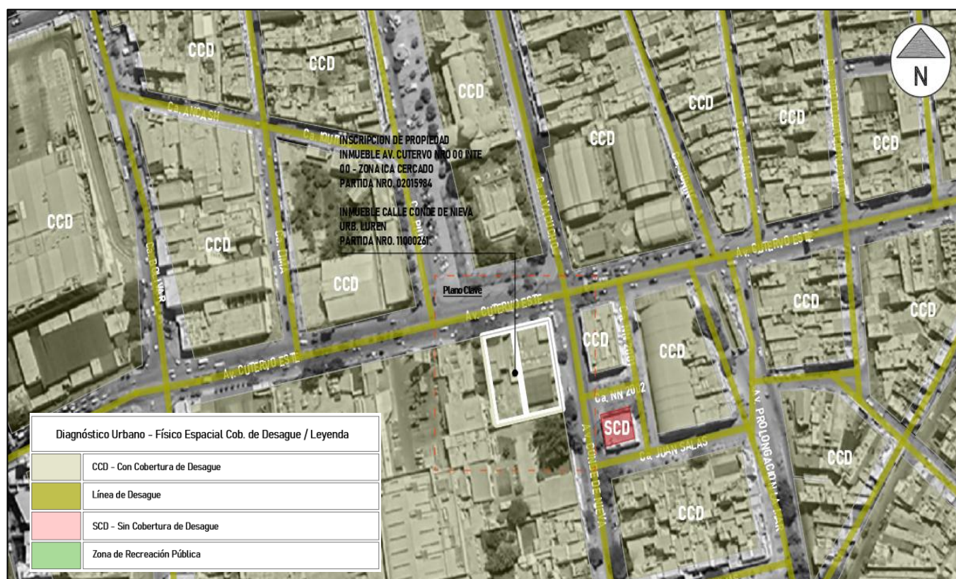
Imagen 31- Plano de Cobertura de Red de Desagüe
