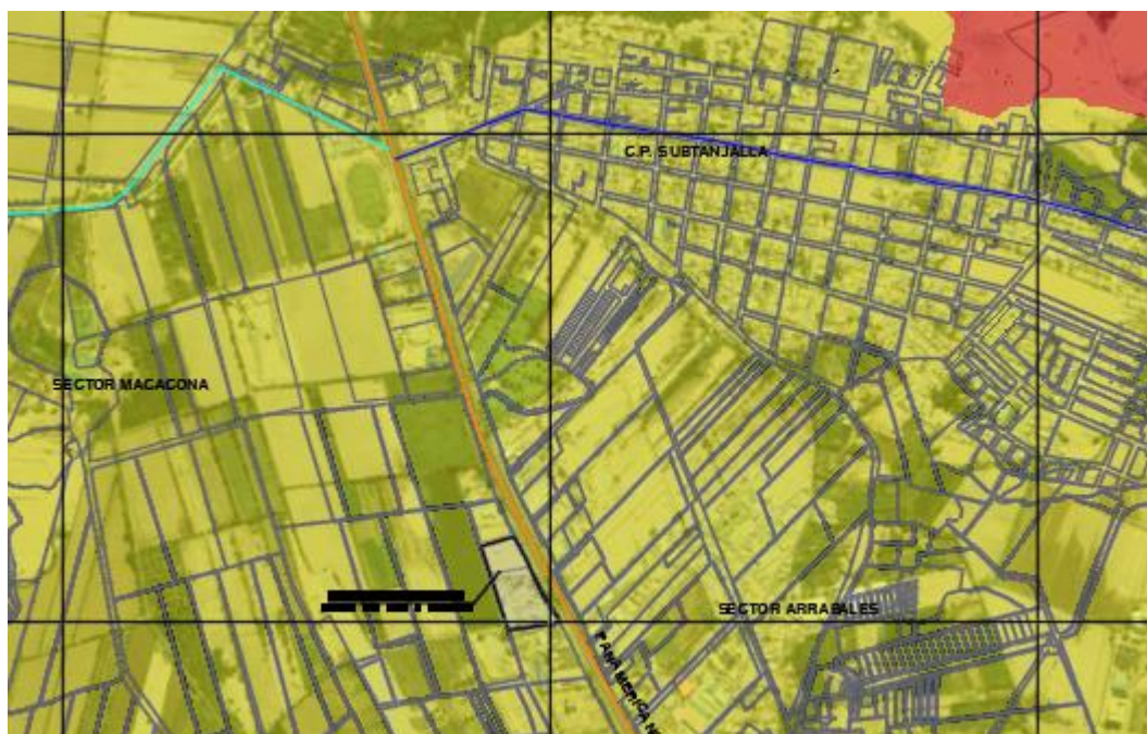
Imagen 32.-Peligro por Sismo (rojo: zona de riesgo alto, amarillo: riesgo medio)
