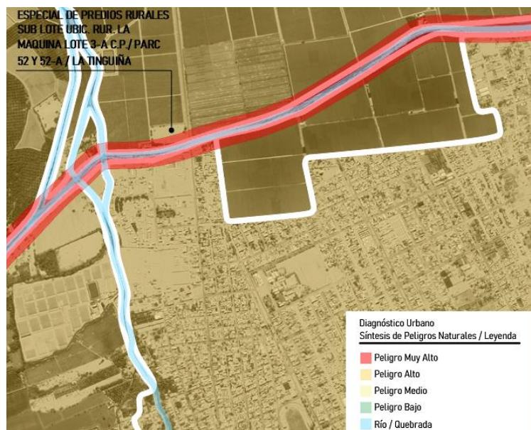
Imagen 46.-Síntesis de peligros (amarillo: peligro medio)
