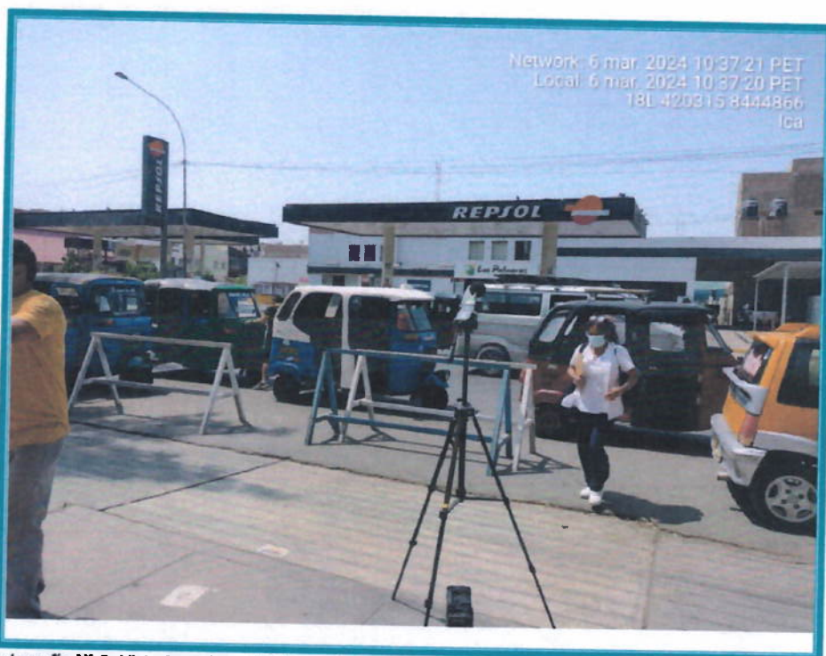
Fotografía N° 2: Vista fotográfica, donde se observa el monitoreo de ruido en el punto de muestreo RUI-1, el 06/03/2024, ubicado en la Av. José Matías Manzanilla – Referencia Ingreso Hospital IV Augusto Hernández Mendoza, en las coordenadas UTM WGS84 N: 8444861 E: 420324.
